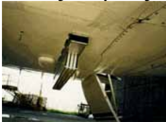
شكل (8-3) يوضح منصات أجهزة البذر لأطلاق الشعلات موضوعة أسفل جسم الطائرة
